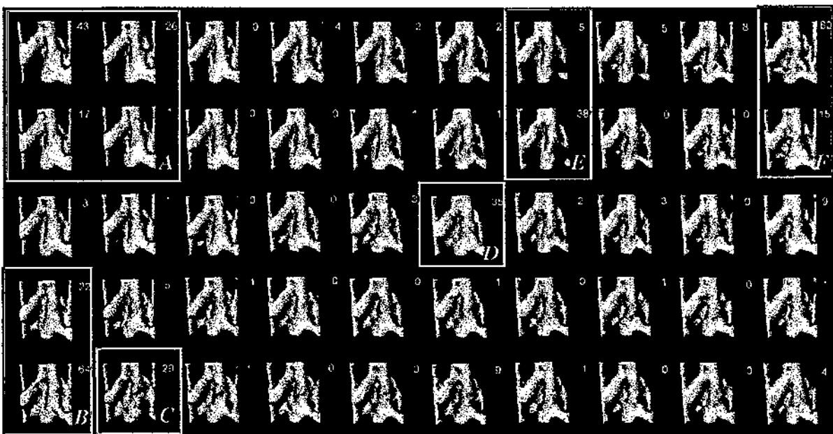
Figura 9.8 Resultados del algoritmo de KerDenSOM en la clasificación de los motivos extraídos del tomograma del IFM. Se utilizó un mapa de 10x5 con topología rectangular y núcleo Gaussiano. El algoritmo se ejecutó en cinco pasos de enfriamiento determinista decrementando el valor de la constante de suavidad desde 300 hasta 50. El número de motivos asignados a cada grupo se muestran en la esquina superior derecha de cada vector diccionario. Los seis grupos que representan las regiones más pobladas del mapa han sido marcados y etiquetados.
