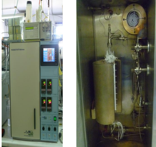
Figura 3.12. Reactor de microactividad utilizado en las reacciones catalíticas. Vista exterior (izquierda) y vista del interior de la caja caliente (derecha).
