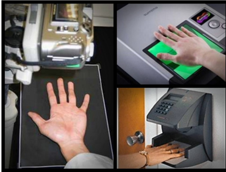
Figura 3.4: Ejemplos de dispositivos de adquisición de huella palmar: cámara digital, escáner sin topes y escáner con topes.
